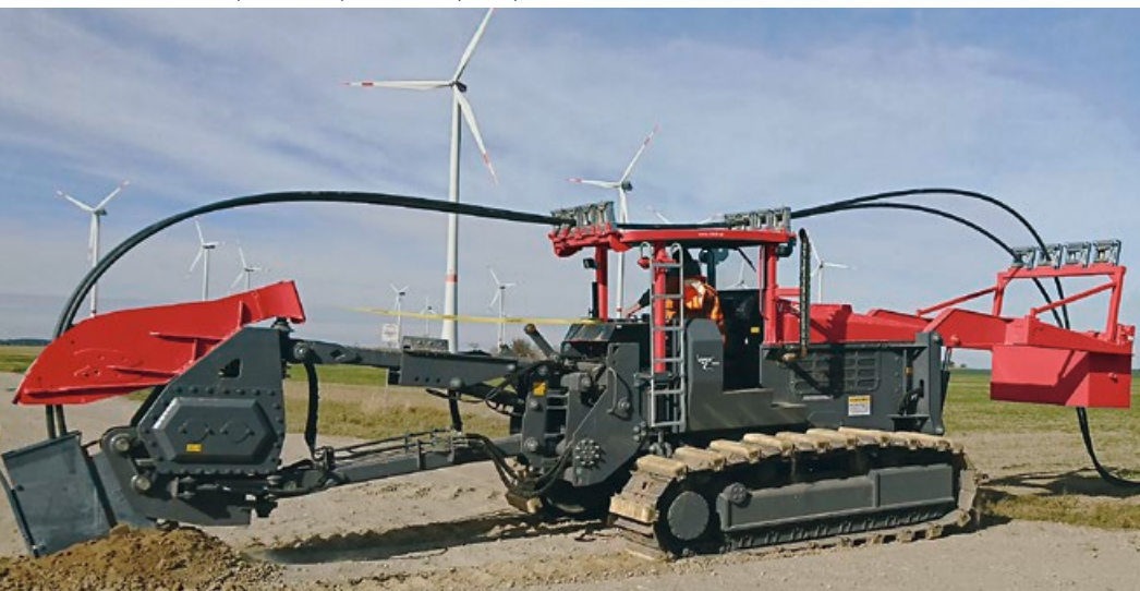
V225 avec patins de protection pour préserver les surfaces revêtues
